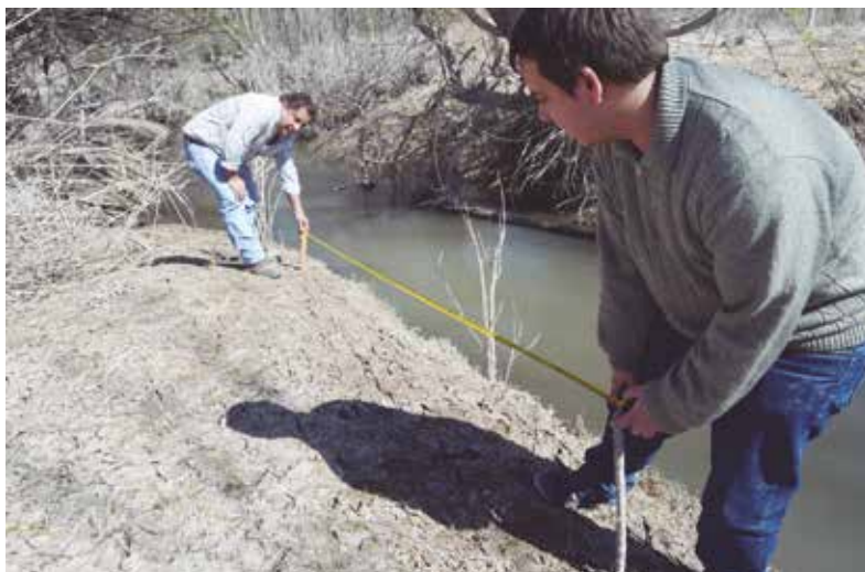
Medición de caudal con el método de área-velocidad con flotador
