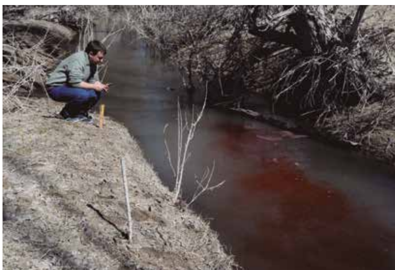
Medición de velocidad por el método por trazador de tinción
