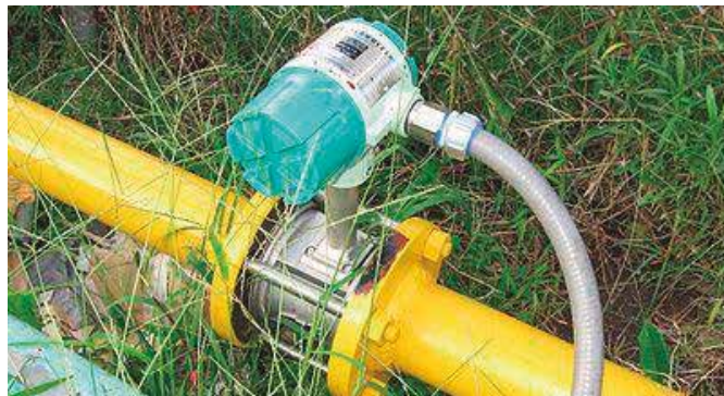
Caudalímetro de inserción en cañería cerrada
