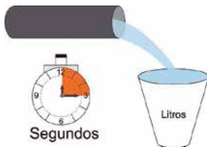
Método de medición directa de caudal
