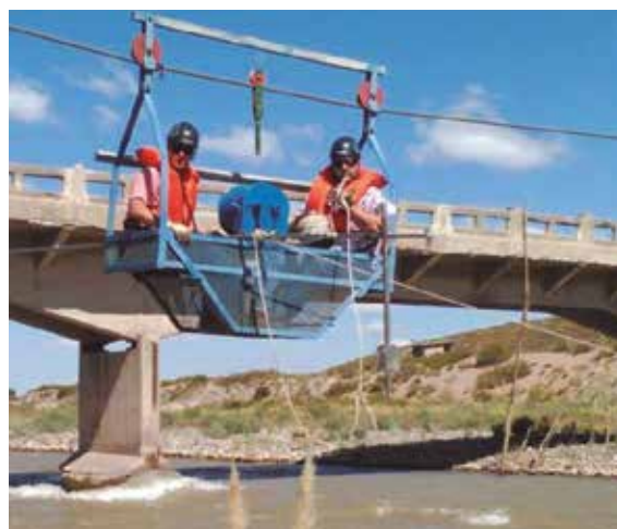
Aforo con barquilla con molinete
