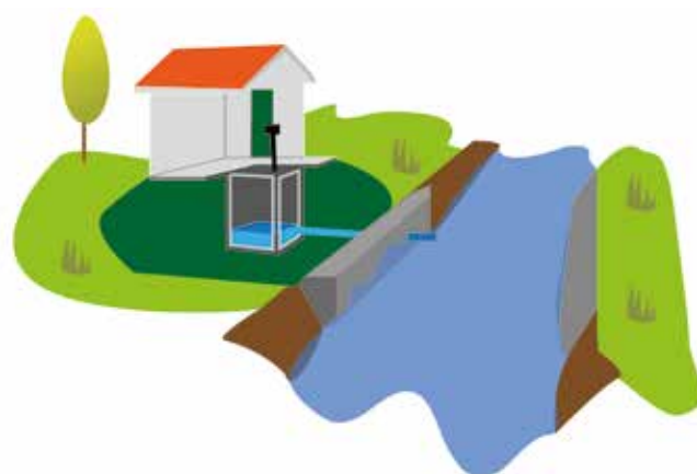
Medición de caudales por el método de altura piezométrica en cámara aquietadora
