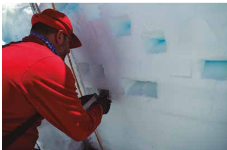
Toma de muestra de las capas de nieve
