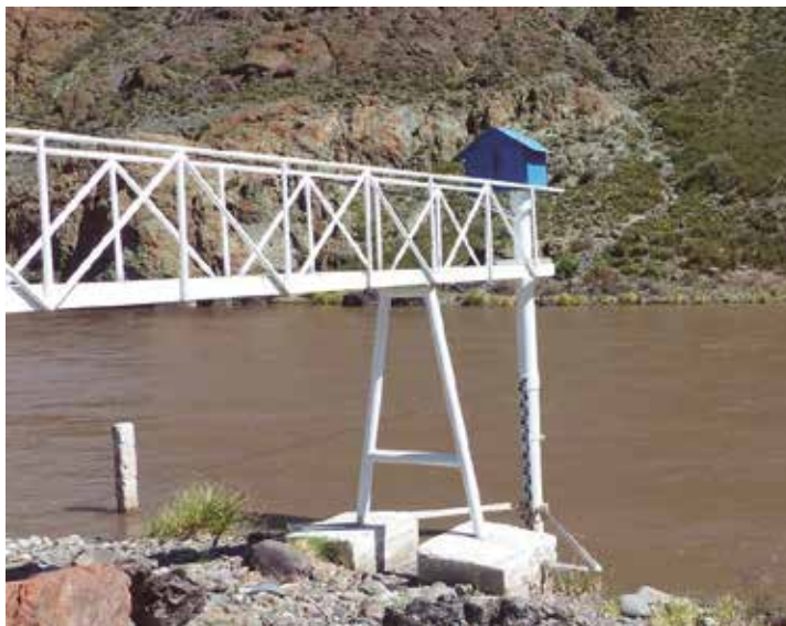
Casilla de alojamiento de un limnómetro en una medición directa en río
