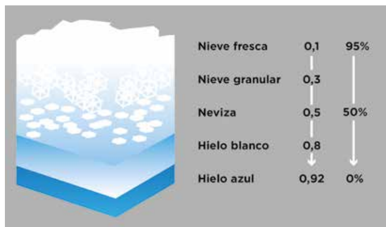
Clasificación de las capas de nieve por su densidad
