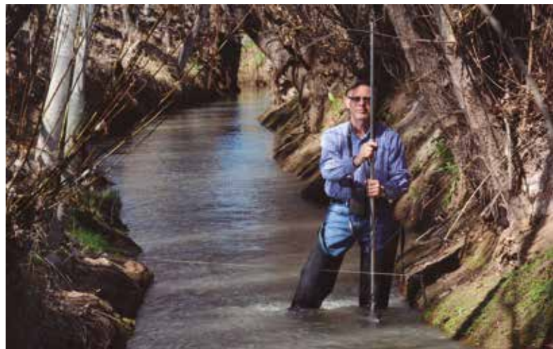
Aforo por vadeo con molinete
