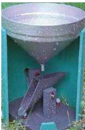
Detalle de pluviómetro a cangilón
