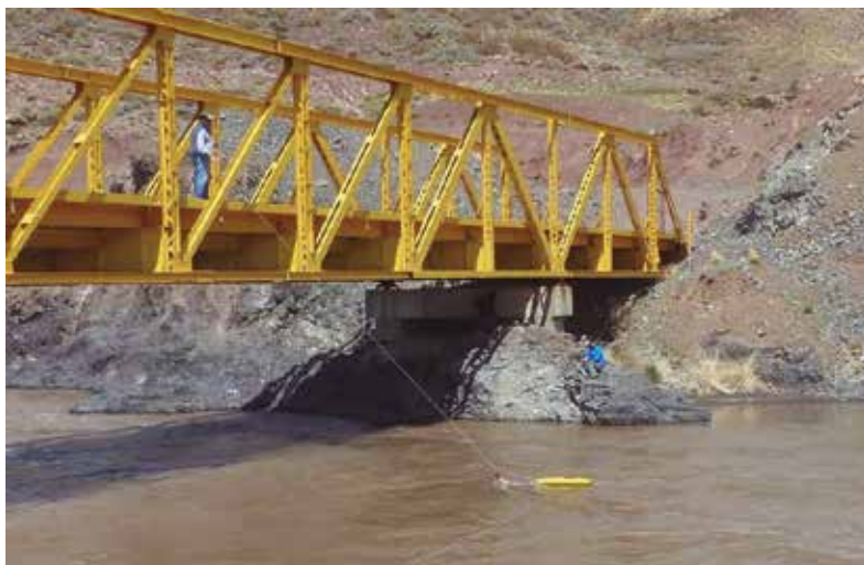
Aforo con sensor ultrasónico de efecto doppler
