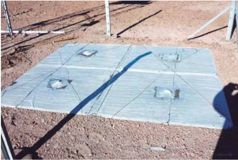
Medición del EAN con colchón de nieve
