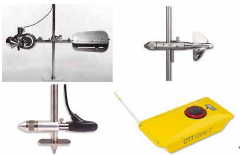
Medición de caudal en canales abiertos por el método área-velocidad
