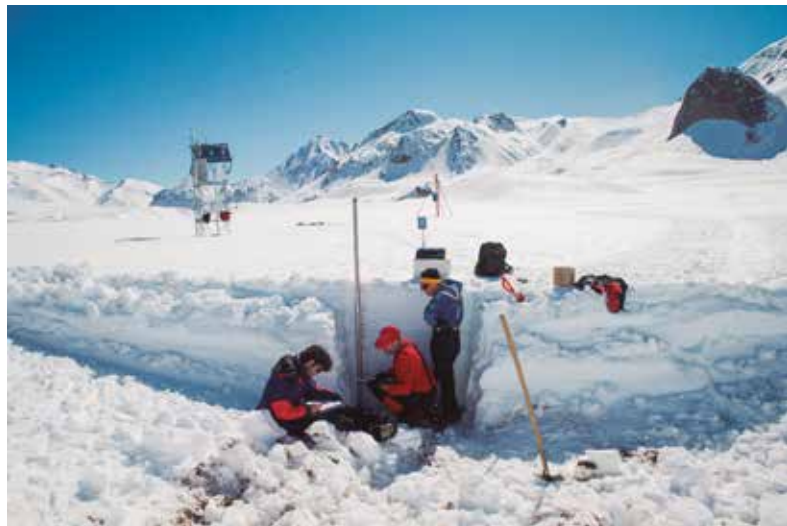
Determinación de las capas de nieve
