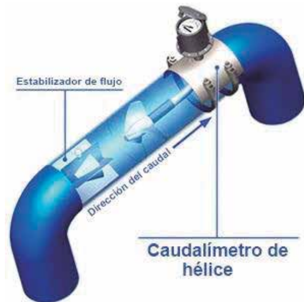
Caudalímetro de inserción en cañería cerrada por el método área-velocidad
