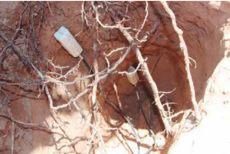
Sensores instalados a diferentes profundidades
