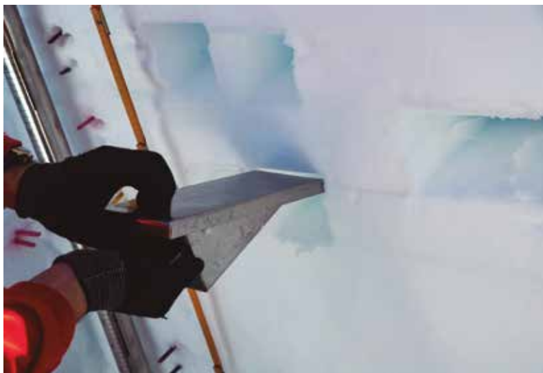
Toma de muestra de las capas de nieve
