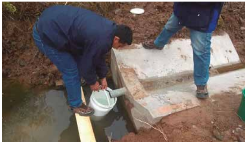
Personal del DGI midiendo caudal de filtraciones en el embalse El Carrizal por el método directo
